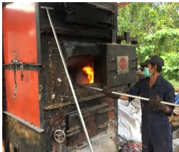
ภาพที่ ๗ การเปิดหน้าเตาเผาขยะเพื่อป้อนขยะที่นานเกินไปทำให้อุณหภูมิในห้องเผาไหม้ลดลง
