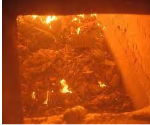
ภาพที่ ๔ การอุ่นเตาเพื่อให้อุณหภูมิภายในสูงตามที่กำหนดไว้และมีอุณหภูมิคงที่
