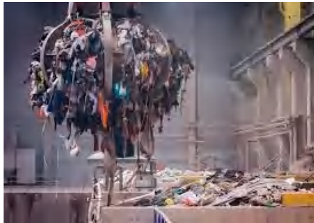
ภาพที่ ๖ การใช้กำบาศขยะเข้าสู่เตาเผาขยะที่สามารถกำหนดปริมาณขยะที่ป้อนได้
